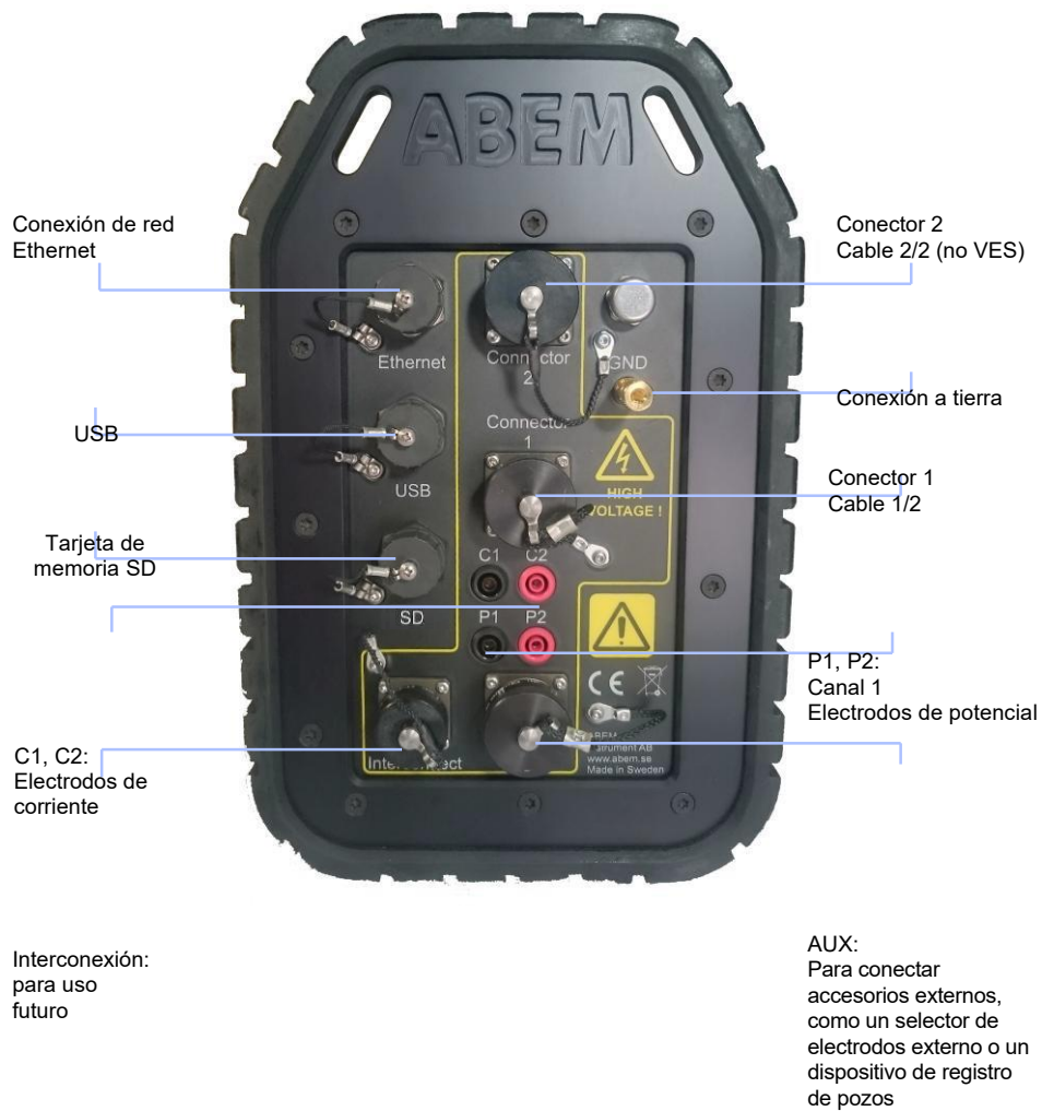
Figura 3 El panel de conectores del Terrameter LS 2
