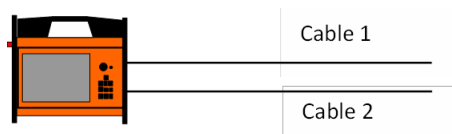
Figura 109 Dos cables conectados para la prueba de aislamiento de cables
