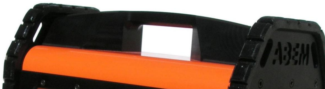
Figura 4 La antena GPS está integrada en el lado izquierdo del mango.
