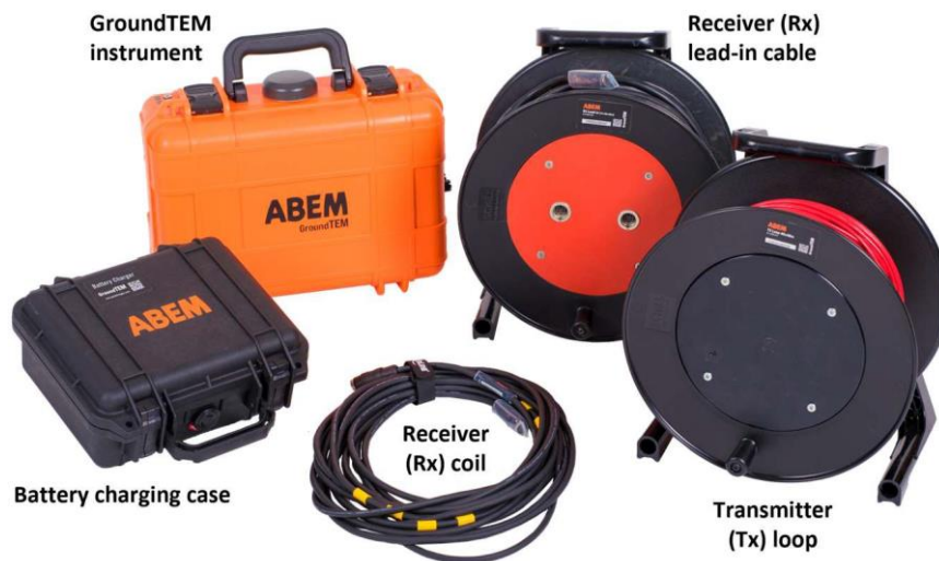
Figura 3. Componentes principales del sistema GroundTEM (aparte del maletín de envío y dos baterías de iones de litio).
