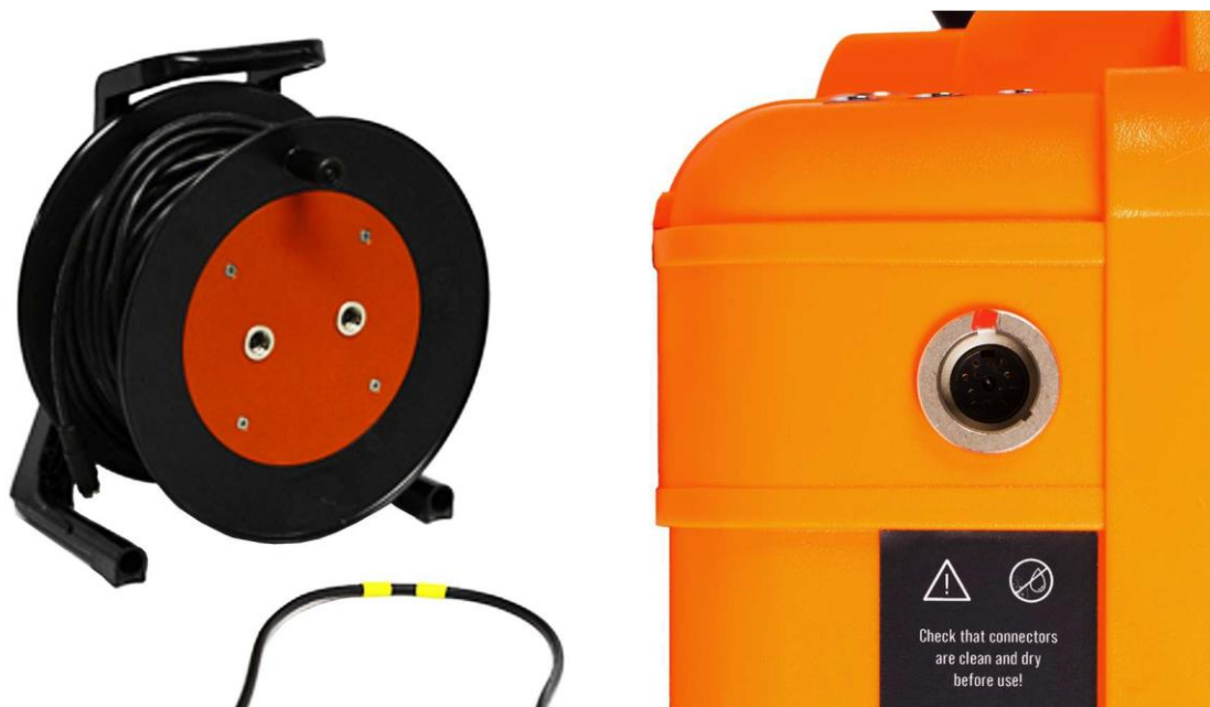
Figura 9. Tambor de cable de entrada (izquierda) con conectores para cable receptor. Marca amarilla que muestra el punto de encuentro entre el cable de entrada y el bucle Tx.
