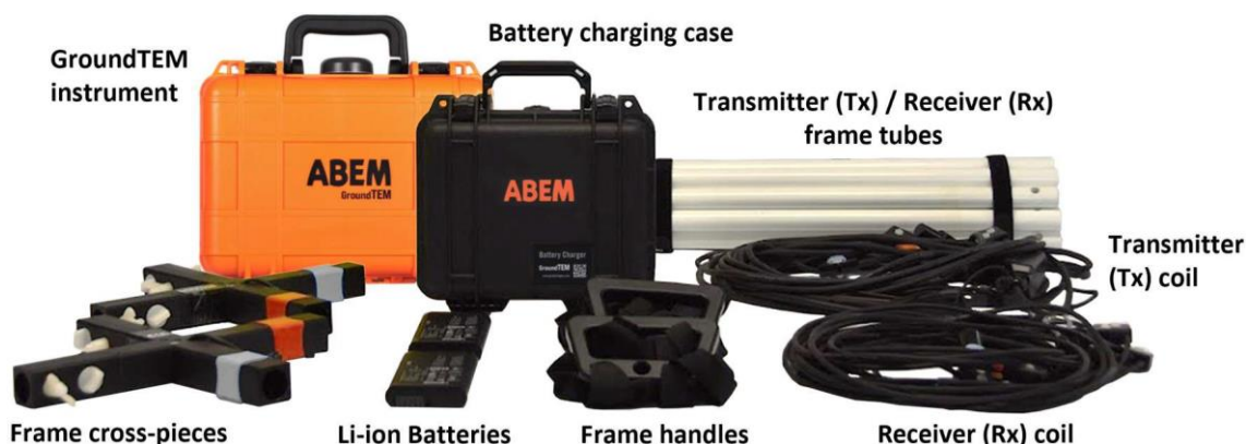
Figura 10. Componentes principales del sistema GroundTEM con bobinas Explorer, el peso total del sistema para una configuración GroundTEM que incluye la unidad GroundTEM y las bobinas Explorer es de aproximadamente 19,5 kg (sin maleta de carga de batería).
