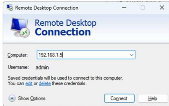
Figura 25. Conexión de escritorio remoto a la unidad GroundTEM. La contraseña y el nombre de usuario son admin. La dirección IP es 192.168.1.5
