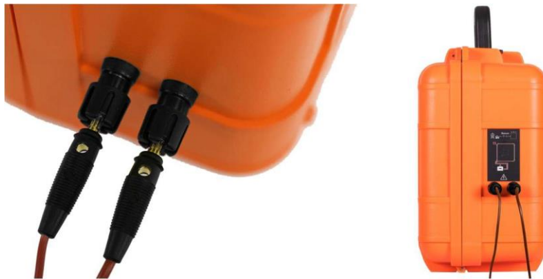
Figura 7. Enchufes tipo banana GroundTEM. Conecte el bucle Tx en cualquier orden.
