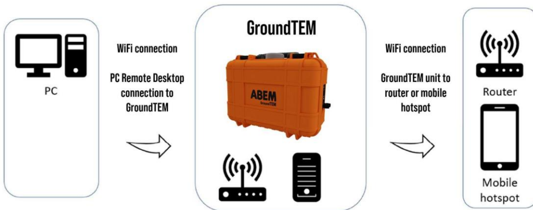
Figura 23. Diagrama de flujo sobre cómo poner en línea la unidad GroundTEM.
