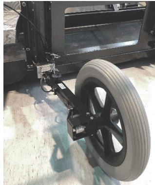
Codificador para montaje en vehículo y rueda de medición de 300 mm.
