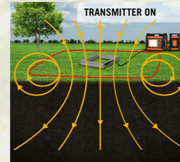
La corriente que fluye en el bucle TX creará un campo magnético (amarillo)
