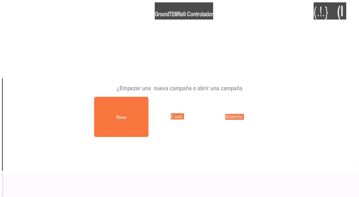
Figura 12: Pantalla de inicio del controlador GroundTEM Ralli donde se elige la campaña. Crea una campaña nueva, continúa la última campaña o abre una campaña antigua y existente.
