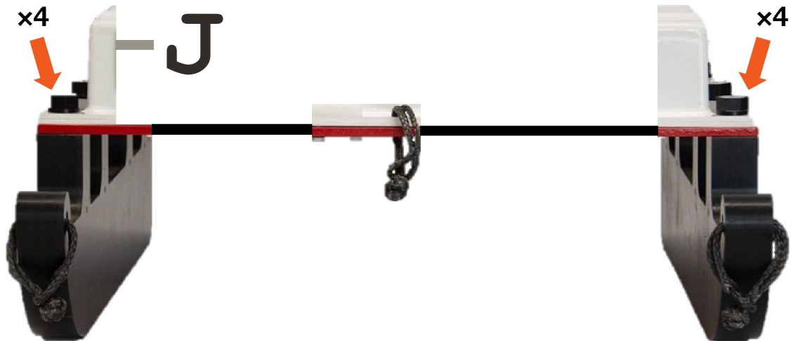
Figura 5 Bobina del receptor montada en plataforma y fijada a los conductos con tornillos
