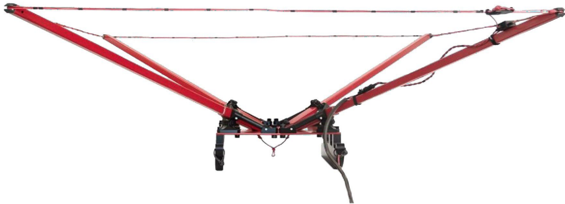
Figura 8: Ejemplo de sistema GroundTEM Ralli con bobina de 331 Tx.
