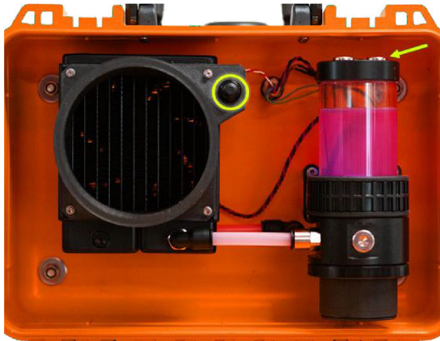
Figura 4: Compartimento de refrigerante de la unidad TX con botón de bypass indicado en círculo rojo.
