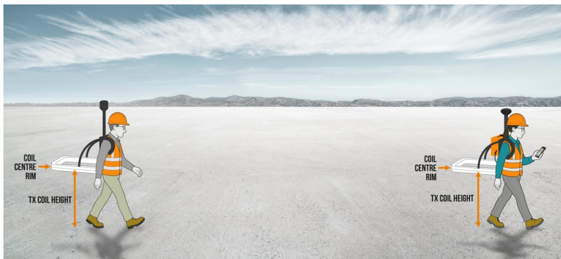
Figura 24: Representación de la medición correcta de la altura de la bobina
