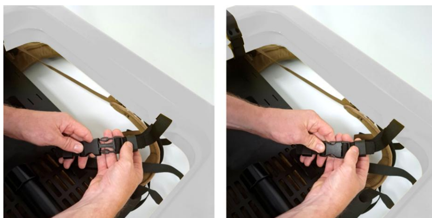
Figura 14: Cómo asegurar las correas de la bobina Rx a las correas de la mochila.
