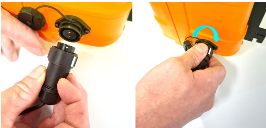
Figura 19: Cómo acoplar el conector a la unidad Tx.
