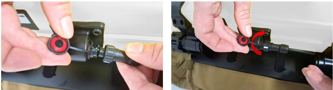
Figura 23: Cómo conectar el cable de la unidad Tx al conector de la bobina Tx.
