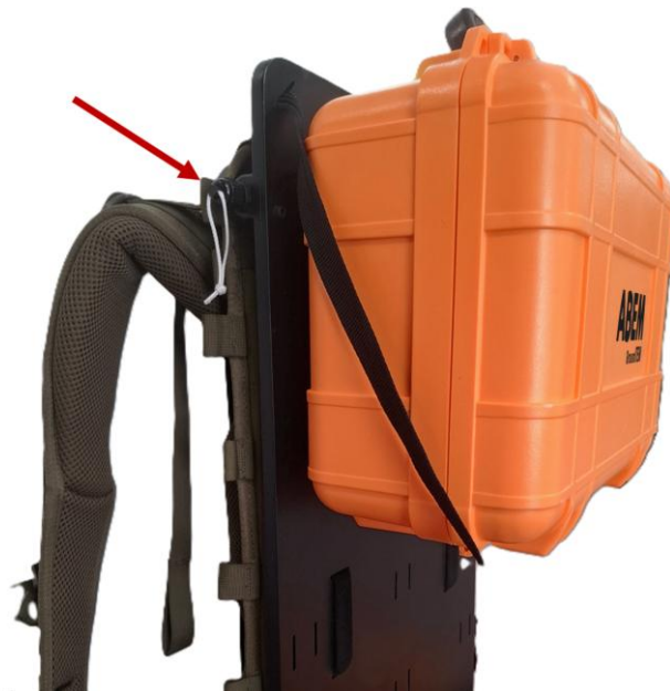
Figura 25: Tire del pasador de seguridad para liberar y desmontar la unidad GroundTEM Trek de la mochila.
