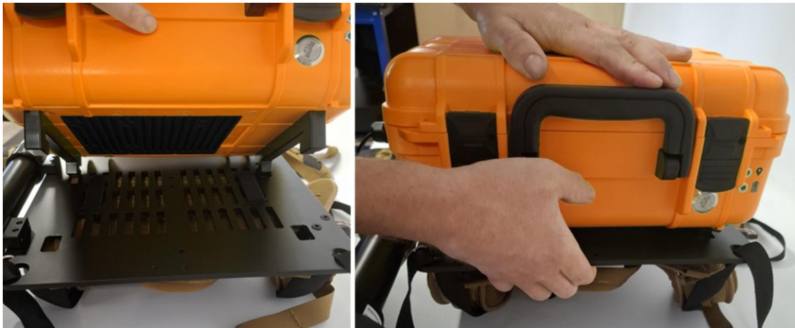
Figura 20: Cómo montar la unidad Tx en la mochila del transmisor.
