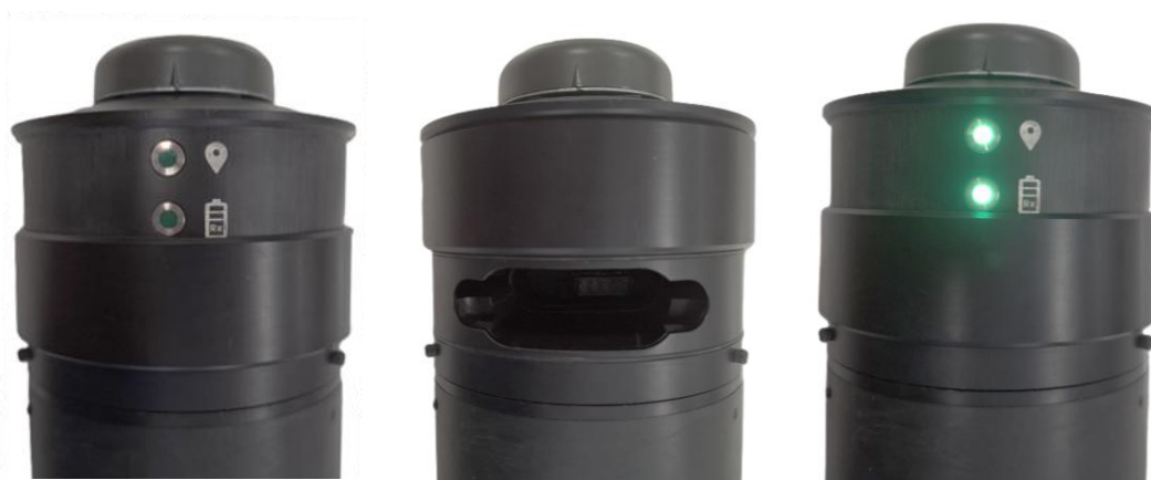
Figura 8: Pasos para encender la unidad receptora. Tras insertar la batería y pulsar el botón de encendido, se encienden las dos luces LED.
