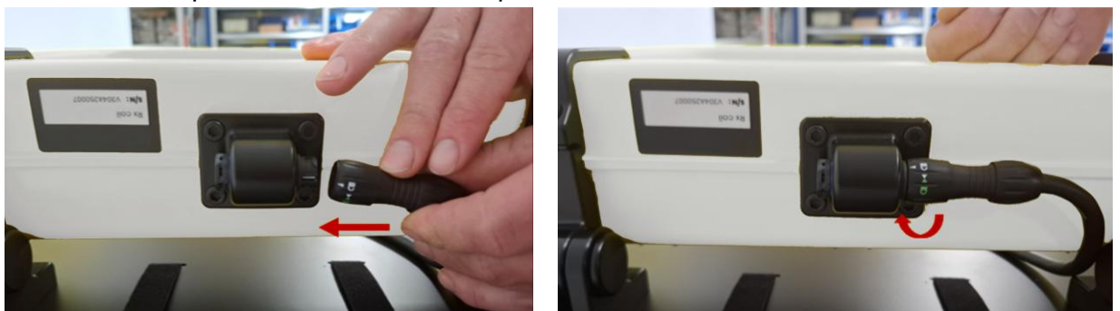
Figura 16: Cómo conectar el cable de la unidad Rx al conector de la bobina Rx.
