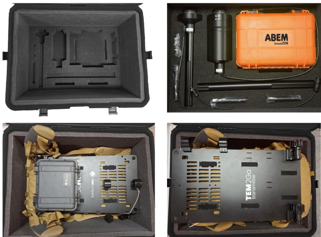
Figura 27: Empaquetado de componentes en el estuche rígido. Comience por colocar los componentes más pequeños en las ranuras designadas de la espuma (arriba). A continuación, empaque las dos placas de la mochila, con el estuche de carga de la batería entre ellas (abajo).
