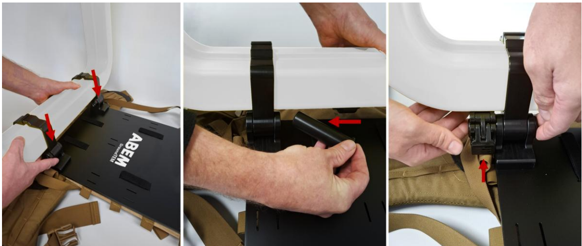
Figura 12: Cómo asegurar la bobina Rx a la mochila del receptor
